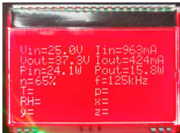
그림 4. 전기자전거 무선 충전 시스템의 측정 파라미터를 출력하는 LCD
